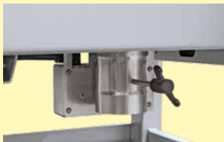
Flap di ingresso aria semiautomatico per l'essiccazione residua nei forni a camera fino a 300 litri
