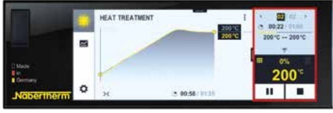
Panoramica dettagliata delle informazioni di processo, inclusi setpoint, valore effettivo e funzioni commutate
