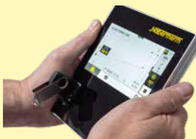
Registrazione dei dati di processo del controller collegato tramite chiavetta USB
