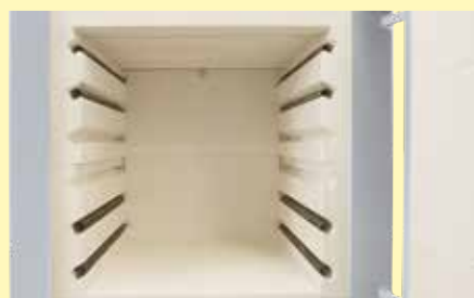
Riscaldamento su due lati tramite elementi riscaldanti in posizione protetta all'interno di scanalature
